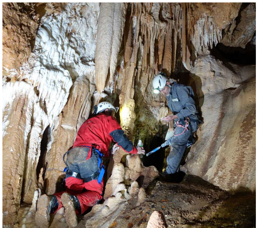
Figure 1. Gabriel Hez à l'eau et Philippe Audra au carottier dans les salles Hautes. L'eau permet d'éviter la surchauffe de l'engin.
